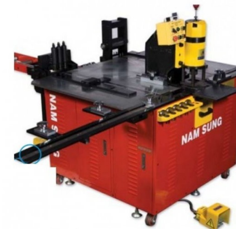
Máy gia công thanh cái
